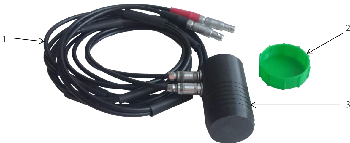
1 – кабель 2Лето-2Лето; 2 – защитный колпачок; 3 – ЭМА преобразователь.
