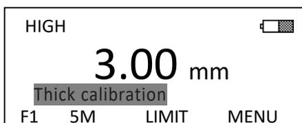
Проведите измерения на эталонном образце с большей толщиной, при помощи клавиш **▼** и **▲** отрегулируйте показания на дисплее до контрольной величины данного эталонного образца. Нажмите на клавишу **ENTER**, операция калибровки завершена.
