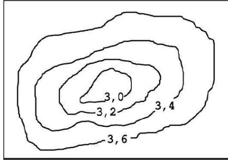
Матричное планирование: проведение измерений (включая вращение ПЭП) по намеченным координатам с получением карты распределения толщины.
