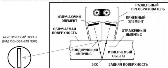
ПЭП – пьезоэлектрический преобразователь
