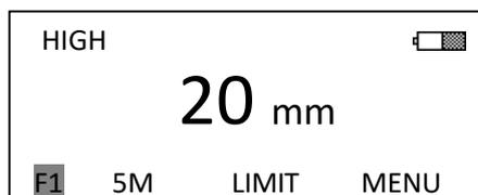
Нажимая клавишу НАСТРОЙКИ при помощи циклического меню в нижней строке дисплея отметьте тёмным фоном параметр F1. Нажимая клавишу ENTER при помощи циклического меню, можно установить номер группы памяти для сохранения результата: F1; F2; F3; F4 или F5. Для выхода и проведения измерений нажмите клавишу СКОРОСТЬ. Каждый раз после проведения измерения и нажатия клавиши ПАМЯТЬ измеренные значения будут сохраняться в номере группы памяти, которую вы выбрали.
