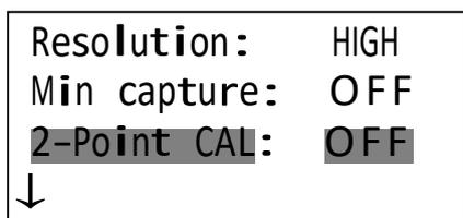
Для поднятия к меню высшего порядка используйте клавишу **НАСТРОЙКИ**, а для быстрого выхода к режиму измерений – клавишу **СКОРОСТЬ**. Если режим калибровки по 2 точкам включён, то в ходе измерений калибровку по 2 точкам можно проводить в любой момент.
