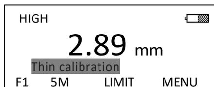
Проведите измерение на контрольном образце с меньшей толщиной, при помощи клавиш **▼** и **▲** отрегулируйте показания на дисплее до контрольной величины данного эталонного образца. Нажмите на клавишу **ENTER**, значение будет зафиксировано и теперь на экране возникнет предложение провести новое измерение уже на эталонном образце с большей толщиной (**Thick calibration**), как это показано ниже:
