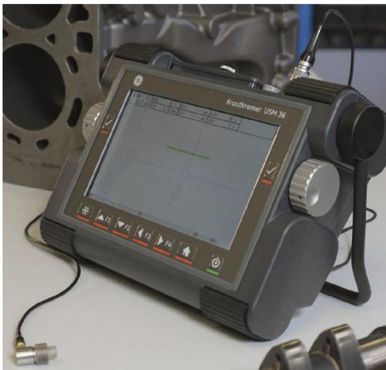
Рисунок 1 – Общий вид дефектоскопов
