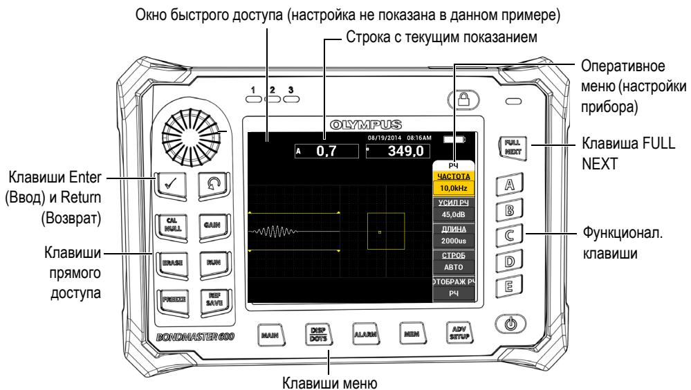
Рис. 3-5 Передняя панель BondMaster 600 и экран измерений
