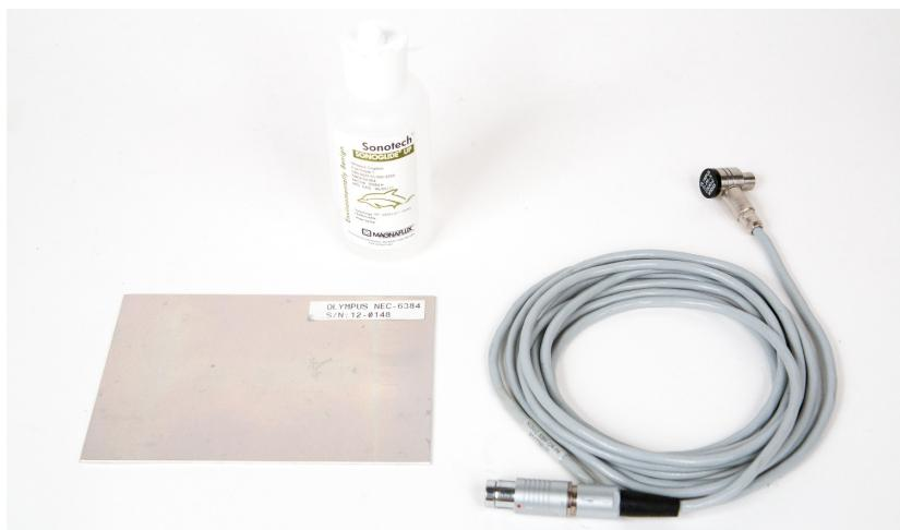
**Рис. 6-37 Материалы для выявления отслоений в металлах – Резонансный режим**
