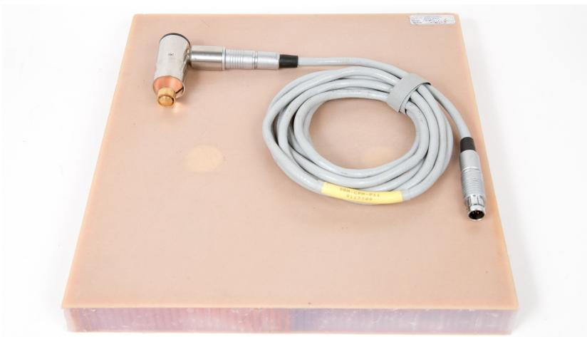
**Рис. 6-61 Материалы для определения наилучшей частоты — Режим МIA**
