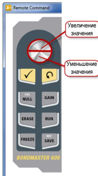
Рис. 7-15 Функции ручки регулятора
