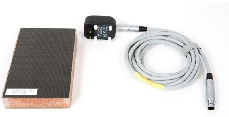
**Рис. 6-1 Материалы для выявления отслоений обшивки в плоских объектах**
