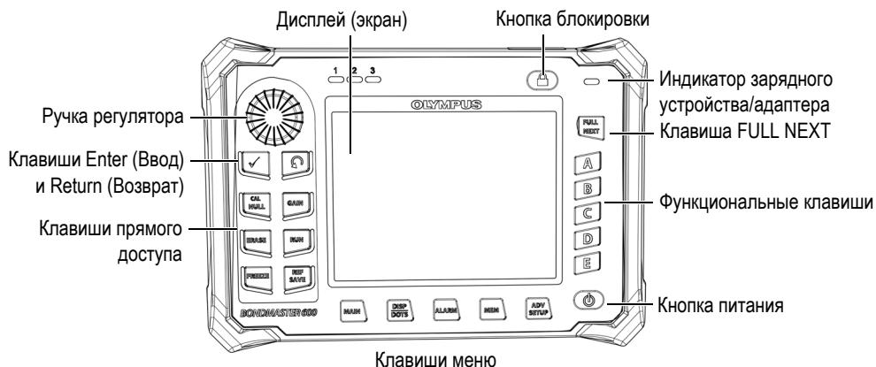
Рис. 2-15 Передняя панель BondMaster 600 – Клавиши и ручка регулятора
