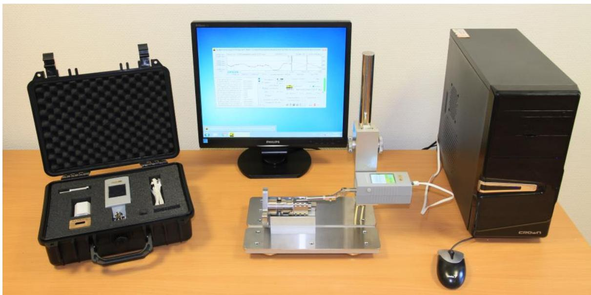
**Рис. 1.** Внешний вид профилометра модели 130 с управляющим компьютером и приводом без автономного режима измерения (см. автономный привод подробнее ниже)
