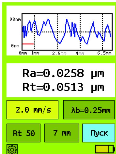
Рис. 7. Органы управления профилометром в автономном режиме
