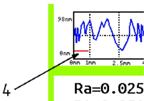
**Рис. 9.** Часть экрана профилометра с изображением ползунка уровня датчика
