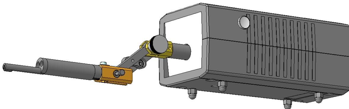
**Рис. 2.** Внешний вид автономного привода, показан механизм подъёма-опускания датчика на деталь произвольной высоты, показаны четыре стандартные опоры для установки привода на габаритные детали, в том числе валы диаметром от 50мм.
