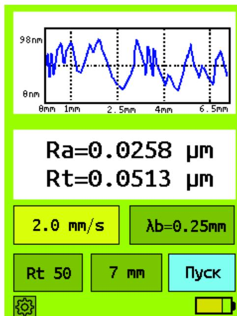
**Рис. 4.** Пример состояния экрана автономного привода, с отображением профиля со шкалой для ориентации в размерах, отображаемых на автономном приводе двух параметров Ra и Rt (Rmax), кнопками выбора скорости, фильтра, шкалы по Rt, длины трассы, доп.настроек, а также с индикатором зарядки аккумулятора (ёмкость аккумулятора 2400мАч, ориентировочно на 200 измерений)
