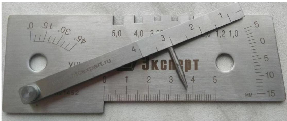
Рисунок 1 - Общий вид шаблона сварщика универсального УШС-3
