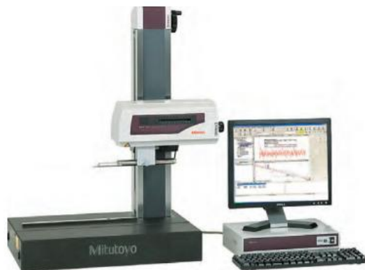
Рисунок 2 – Общий вид приборов Surftest SV-2100
